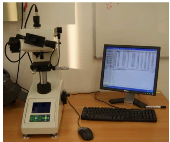
3. ábra Wolpert keménységmérő készülék
